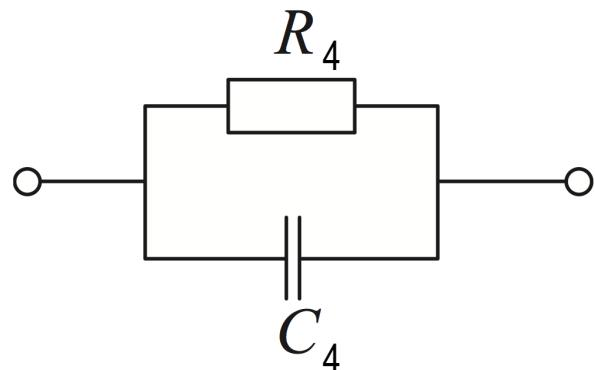
$$\underline{Z} = \frac{R_4 - j\omega C_4 R_4^2}{1 + \omega^2 R_4^2 C_4^2}$$
